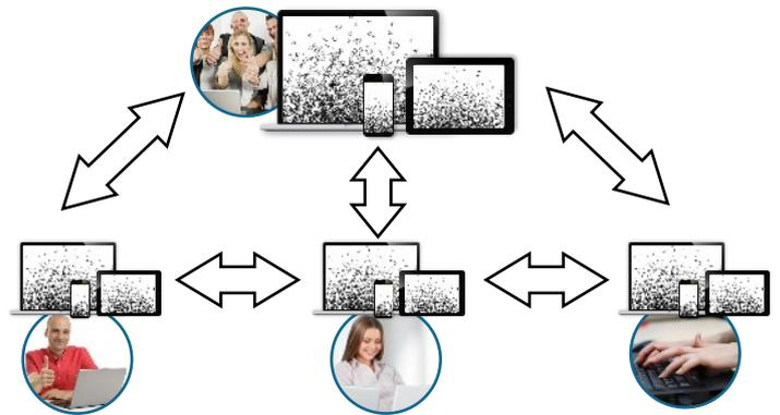
Exemple d'un réseau communautaire dit « maillé » : chaque point du réseau est indépendant et diffuse vers les autres points du réseau.
